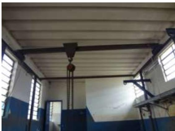
Figura 11 - Sistema de içamento
