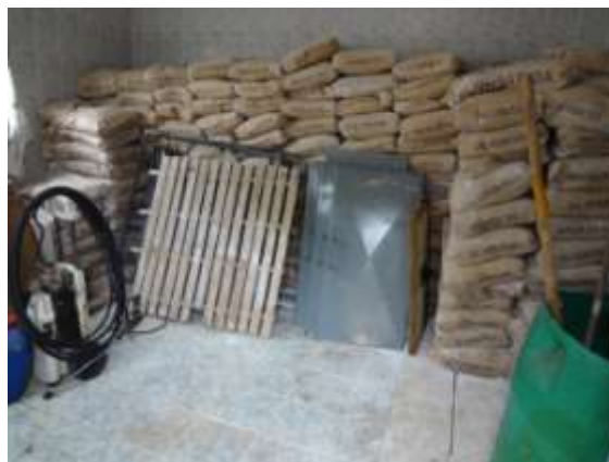
Figura 22 - Armazenamento de Cal Hidratada
